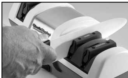
Малюнок 5. Заточка керамічних ножів на Етапі 2 Ceramic.
