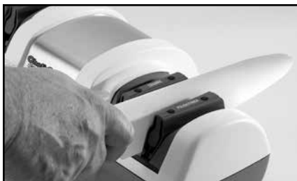
Малюнок 6. Етап 3 для полірування / доводки керамічних ножів.
