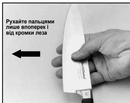
Малюнок 5. Задирок легко помітити, якщо провести пальцями впоперек і від кромки леза. УВАЖНО! Див.текст.
