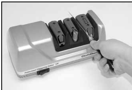
Рисунок 6. Вставьте лезвие в левый паз Устройства 3. Чередуйте левый и правый пазы.
