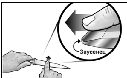
Рисунок 4. Добейтесь образования заусенца вдоль всей кромки лезвия перед полировкой в Устройстве 3.
