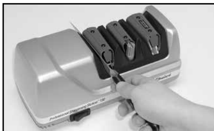
Малюнок 3. Етап 1. Вставте лезо у паз між кутовою направляючою та пластиковою пружиною. Чергуйте протяжки в лівому та правому пазах.
